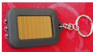
Porte clé lampe alimenté par une photopile
