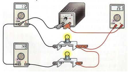
Les multimètres fonctionnent en ampèremètre sur le calibre 2000 mA.
