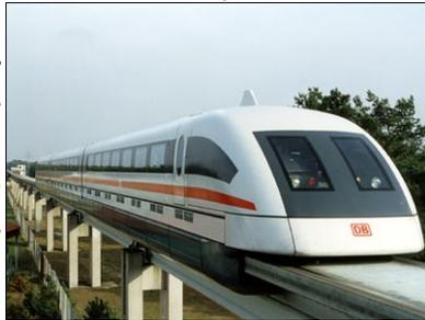
Les trains à sustentation magnétique utilisent des bobines supraconductrices
