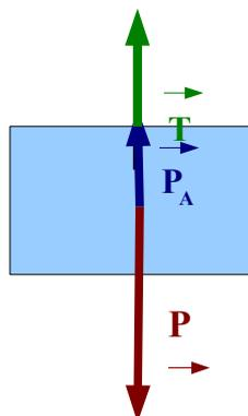
**Remarques :** La caisse n'étant pas en contact avec le fond de la mer, il n'y a pas de réaction du support. De plus la caisse étant immobile, il n'y a pas non plus de force de frottement fluide.
