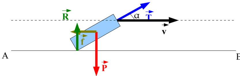
La voiture est en mouvement rectiligne uniforme, donc d'après la première loi de Newton on en déduit que la résultante des forces est nulle.
